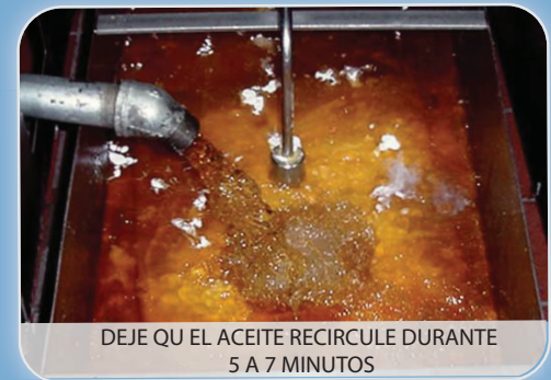
DRENE AL ACEITE DE LA FREIDORA EN EL RECIPIENTE DE FILTRADO
